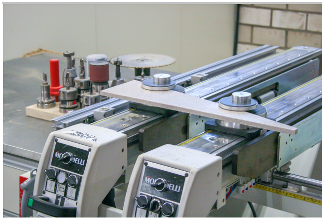
Механические зажимы VCMC-S4 для зажима деревянных деталей
